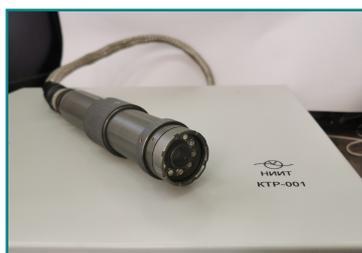
Благодаря использованию передающей трубки типа видикон камера обладает повышенной радиационной стойкостью и высоким качеством изображения.
